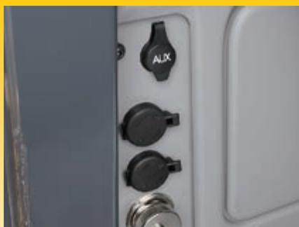
Audioanschluss (MP3-Anschluss) und zwei 12 V Steckdosen
