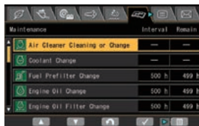
Ein Multifunktionsmonitorsystem ermöglicht die Anzeige und Einstellung von zahlreichen Betriebs- und Wartungsdaten
