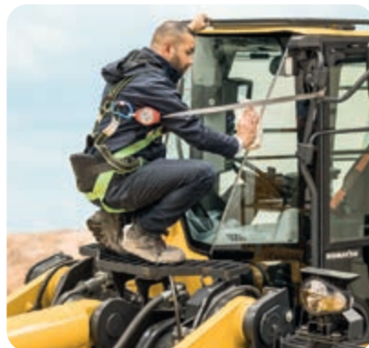
Die Trittfläche vor der Kabine ermöglicht eine sichere und leichte Reinigung der Windschutzscheibe
