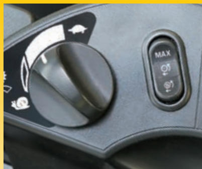
Stufenlose Geschwindigkeitsregelung mit neuer variabler Kriechganggeschwindigkeit (links) und Schalter für einstellbares Zugkraftkontrollsystem (rechts)
