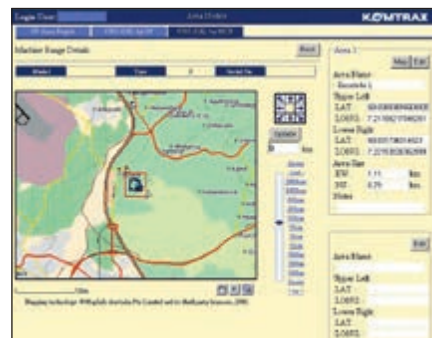
Gesteigerte Sicherheit – Mit Hilfe der Motorsperrfunktion lässt sich festlegen, wann die Maschine gestartet werden darf. Die Geofence-Funktion benachrichtigt den Maschinenbesitzer, sobald die Maschine einen festgelegten Einsatzbereich verlässt.
