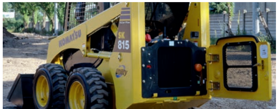
Die große Heckklappe erleichtert Inspektion und Reinigung des Kühlers.
