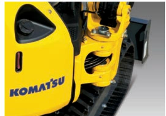
Zur Minimierung des Überstandes wurde der Schwenkzylinder auf die linke Maschinenseite verlegt, um entlang von Wänden oder Hindernissen problemlos arbeiten zu können.
