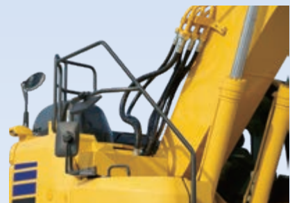
Handläufe und rutschfeste Oberflächen
