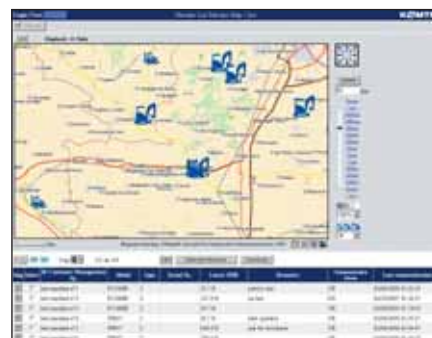
Flottenstandort – Anhand der Maschinenliste lässt sich auf einen Blick der Standort der Maschinen ablesen, auch wenn sie sich im Ausland befinden.
