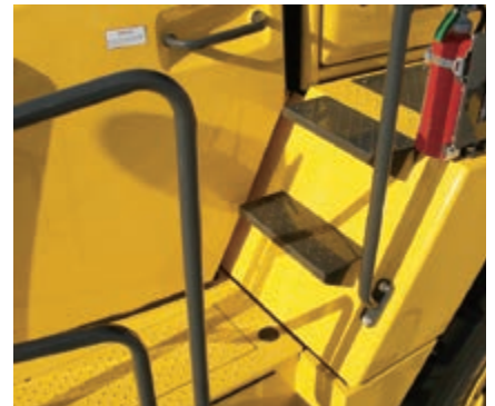
Handlauf für sicheren Zugang zum Fahrerhaus in sicherer Entfernung zum Gelenkbereich
