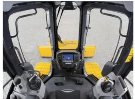
Maximaler Fahrerkomfort und hervorragende Sicht auf den Schild dank stark abgeschrägter Front
