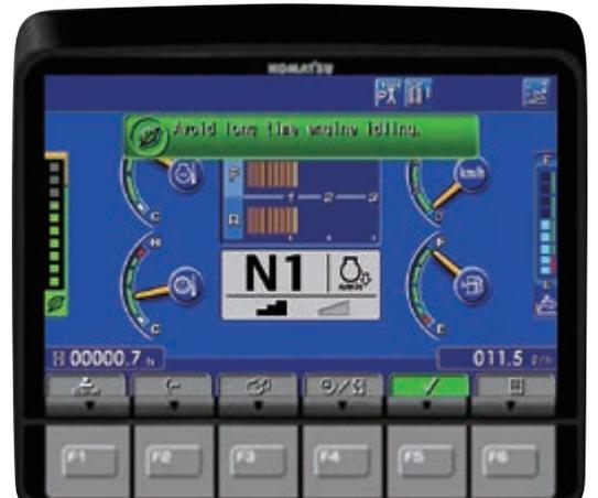
Eco-Anzeige, Eco-Hinweise und die neue automatische Leerlaufabschaltung unterstützen den kraftstoffsparenden Betrieb der Maschine.
