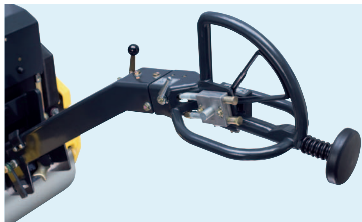
CE-konforme und höhenverstellbare Führungsdeichsel für höchste Sicherheit und besten Bedienkomfort.
