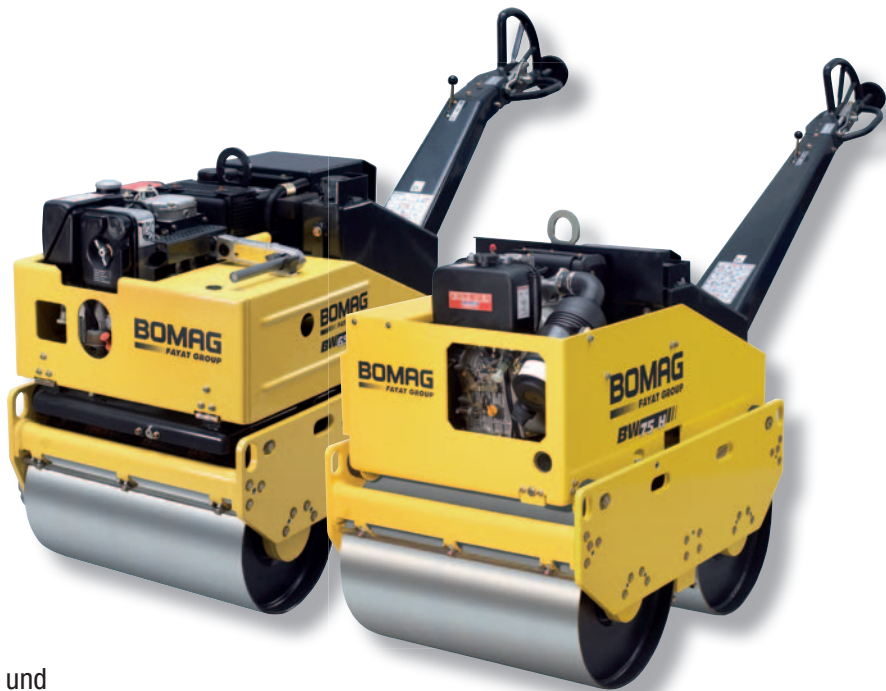
Mit einzigartigem Doppelvibrationssystem: BOMAG BW 65 H und BW 75 H.
